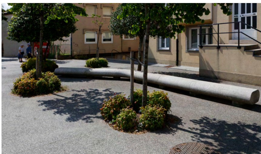
Banco prefabricado de formigón en Santiago de Compostela.
